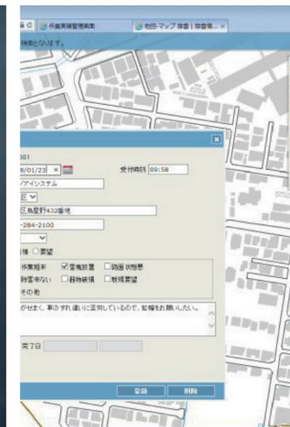
が、除雪作業終了後に市役所に届けられて初めて把握できるという状況だった。そこで、除雪車にGPS装置を設置し、それを地図情報と組み合わせることで、リアルタイムに除雪情報を共有できるシステムを独自に開発。行政への導入提案を強化したいと考えていた。
